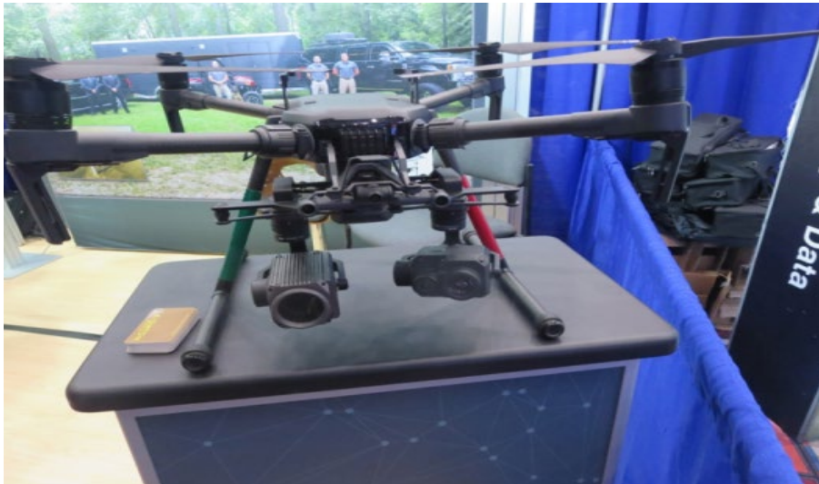
(G I T A North America コンファレンスの展示に展示された天然ガスパイプラインのガス漏洩検査のためのドローン)
